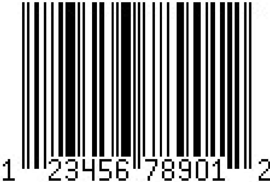
*Figure 3-3 : Code-barres UPC-A*
